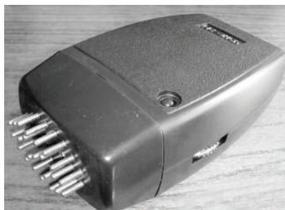
Аппарат для чрескожной электро- нейростимуляции (ЧЭНС)
